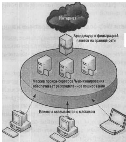
Рис. 11.1. Функционирование распределенного кэширования
