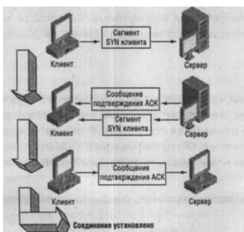
Рис. 10.42. Использование TCP-протоколом трехстороннего квитирования для установки соединения между клиентом и сервером
